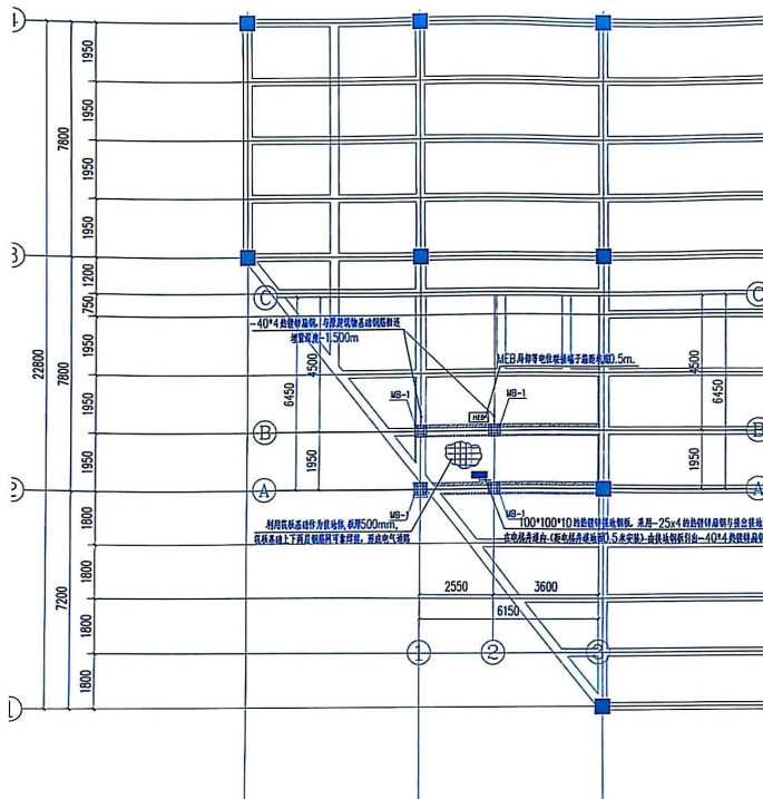
基础接地平面图 1:100
