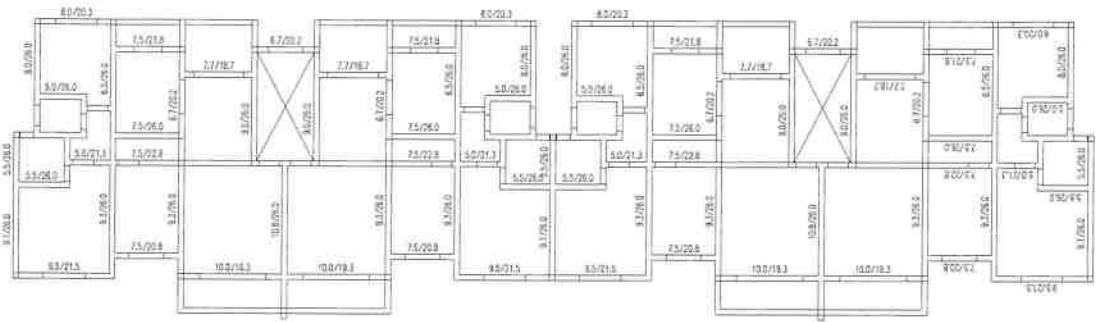
2 层墙高厚比验算图(高厚比 \beta /允许高厚比 [\beta] )
