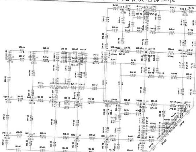
图 2 原楼面梁柱配筋及板配筋图(单位: cm 2 )
